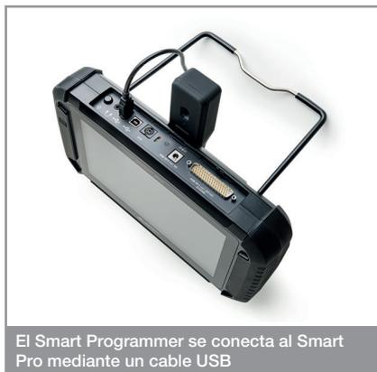
El Smart Programmer se conecta al Smart Pro mediante un cable USB
